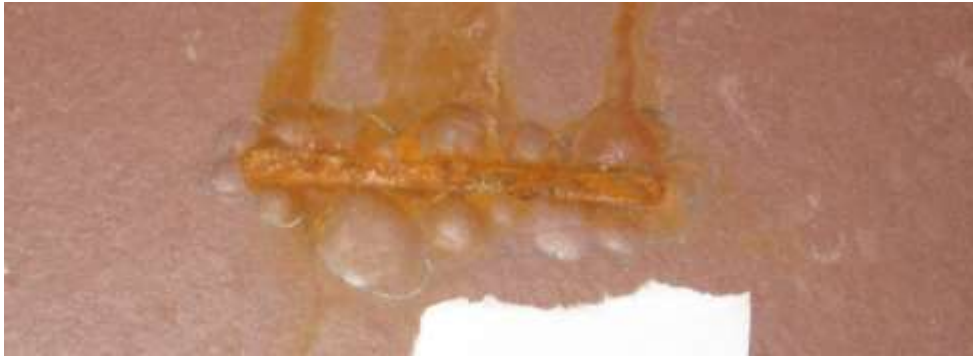
図 C-3 粘着性のない塗装を剥がす前のウェーブタンク試験の天井試験片におけるスクライブ範囲(このモデル報告書の結果例は写真例と関係ない)
