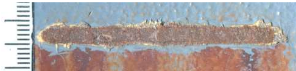
図 C-5 ウェーブタンク試験の側面試験片におけるスクライブからのさび幅 (冷却なし) (このモデル報告書の結果例は写真例と関係ない)
