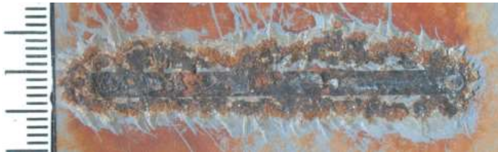
図 C-4 ウェーブタンク試験の天井試験片におけるスクライブからのさび幅 (このモデル報告書の結果例は写真例と関係ない)
