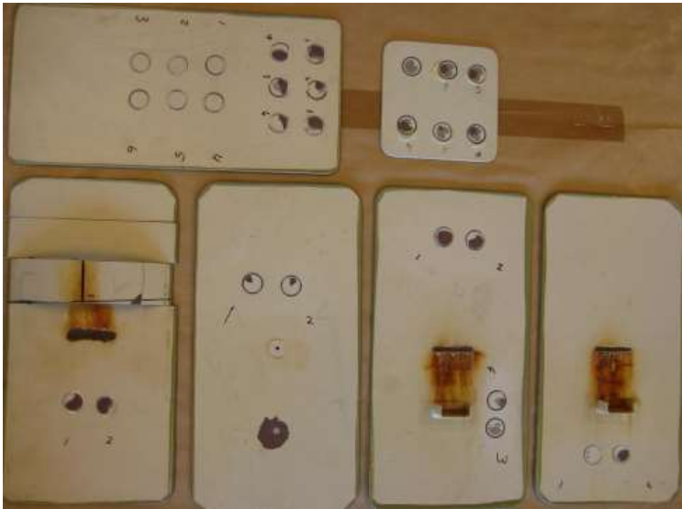
図 C-1 ウェーブタンク及び加熱室における暴露後の試験片の概観写真。 右上には暴露されていない参照試験片。試験後に撮られた写真。 (このモデル報告書の結果例は写真例と関係ない)
