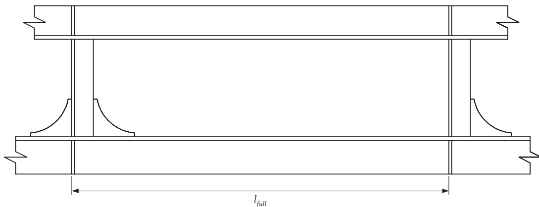
図 3.5.4 防撓材のスパン l_{full} の定義
