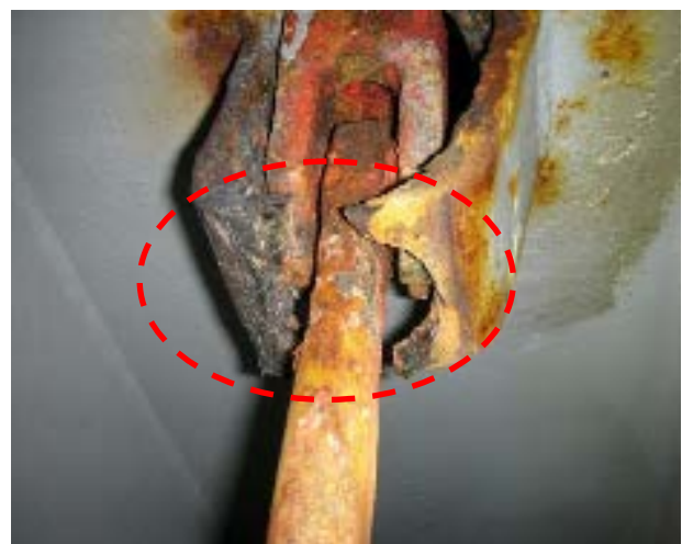
締付装置受け部(Crutch)の衰耗/損傷
