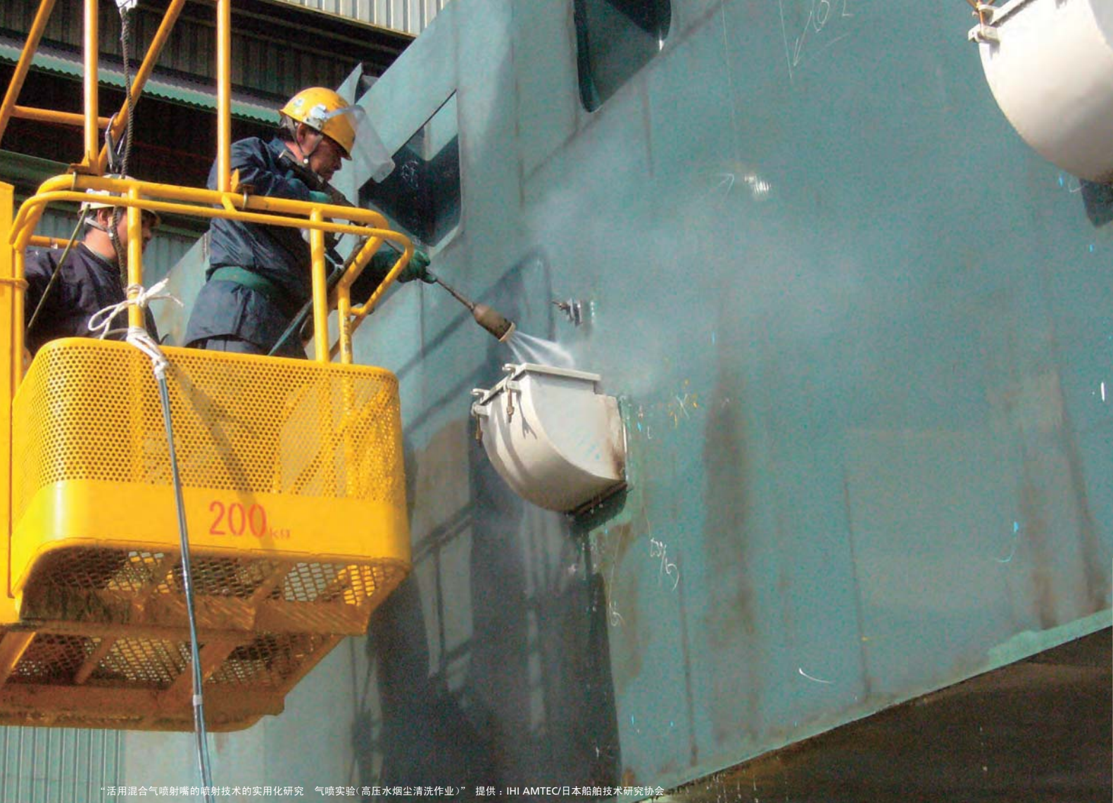
“活用混合气喷射嘴的喷射技术的实用化研究 气喷实验(高压水烟尘清洗作业)” 提供：IHI AMTEC/日本船舶技术研究协会
