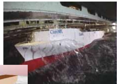
بالأعلى: اختبار جر الخزانات للتحقق من رد فعل سفن الحاويات العملاقة لحركة الارتجاج بالأسفل: محاكاة بالكمبيوتر لرد فعل سفن الحاويات العملاقة للأمواج العالية
