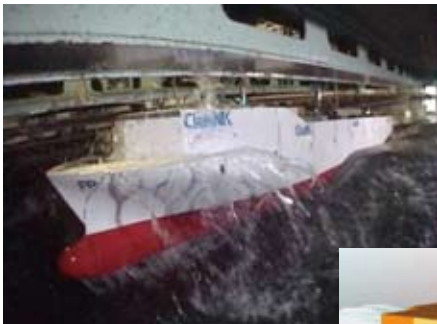
Üst: Büyük konteyner gemilerinin piyan tepkisi için çekme tankı testi
