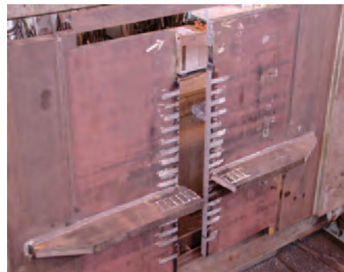
大型脆性破壊試験
