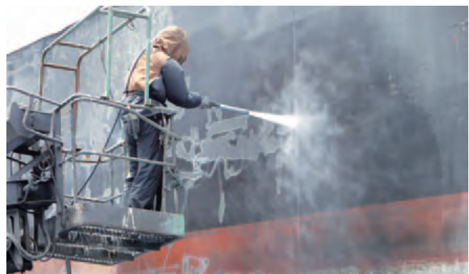
就航船での混気ジェット装置の実証試験
