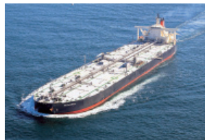
HORAISAN PETROLEIRO de 160.057 gt, construído pela MITSUBISHI HEAVY INDUSTRIES, LTD. NAGASAKI SHIPYARD & MACHINERY WORKS para a Mitsui O.S.K.Lines, Ltd.
