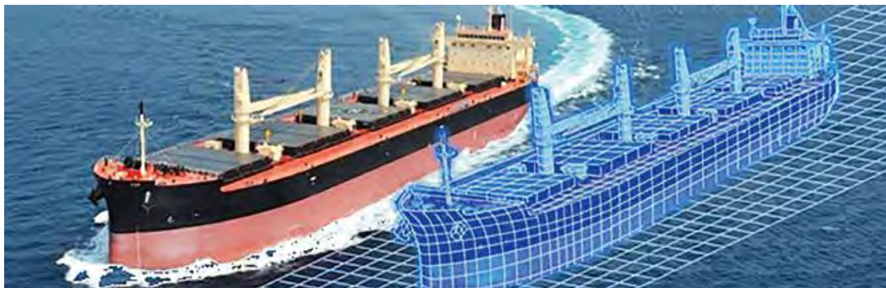
個船毎に設計、建造、運航の一生に渡るデータを一元管理、デジタル上に3次元モデルで再現
