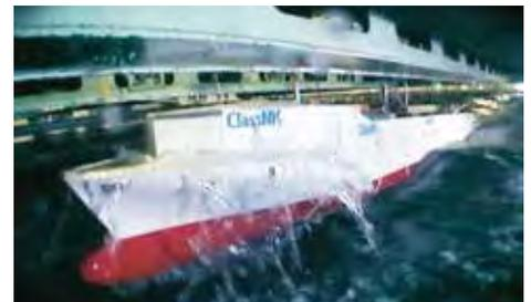
Uji "Towing tank" untuk menguji respons kapal kontener besar terhadap terpaan ombak.
