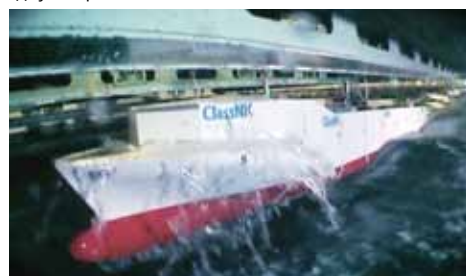
Испытания в опытовом бассейне: воздействие ударов волн на сверхкрупные контейнеровозы
