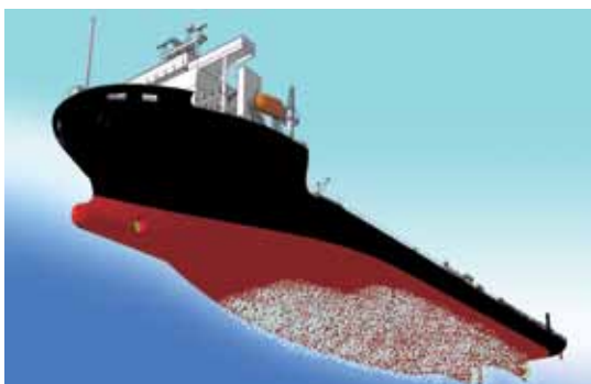
Система «пневмосмазки» для снижения сопротивления трения между днищем и водой.
