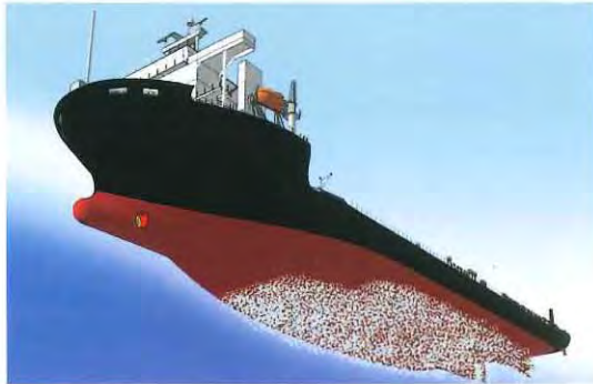
Karına ve su arasındaki sürtünme dayanımını azaltan hava yağlama sistemi
