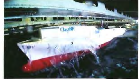
Büyük konteynır gemilerinin suyun gemiye çarpma tepkisine ilişkin çekme tankı deneyi
