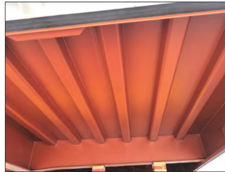
U型ビームを使用したハッチカバー (裏面)
