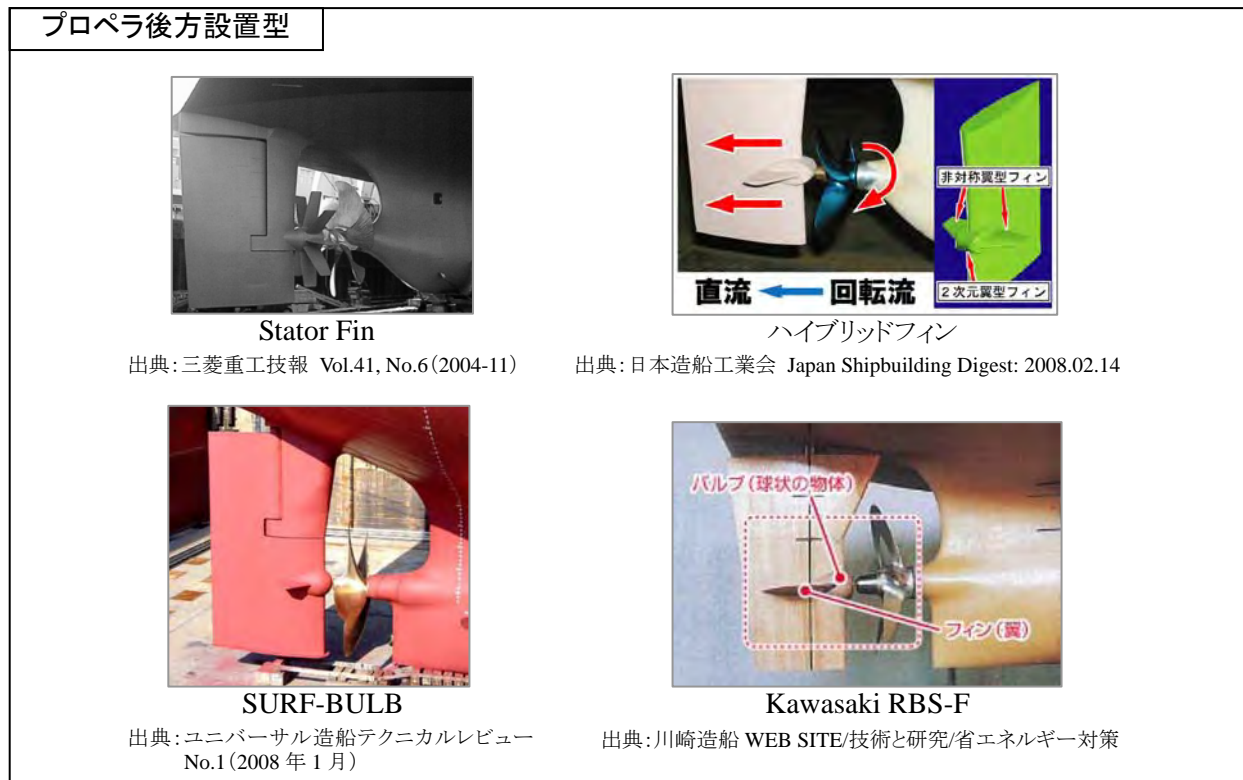
図5 推進効率改善のための省エネ装置（プロペラ後方設置型）
