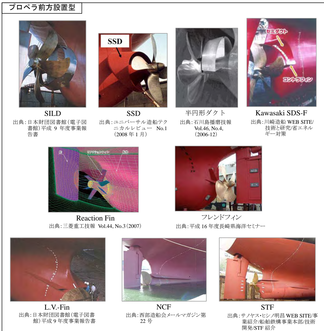
図4 推進効率改善のための省エネ装置（プロペラ前方設置型）
