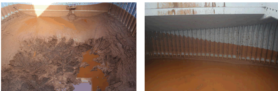
図 4 航海中に貨物倉内で液状化したニッケル鉱
