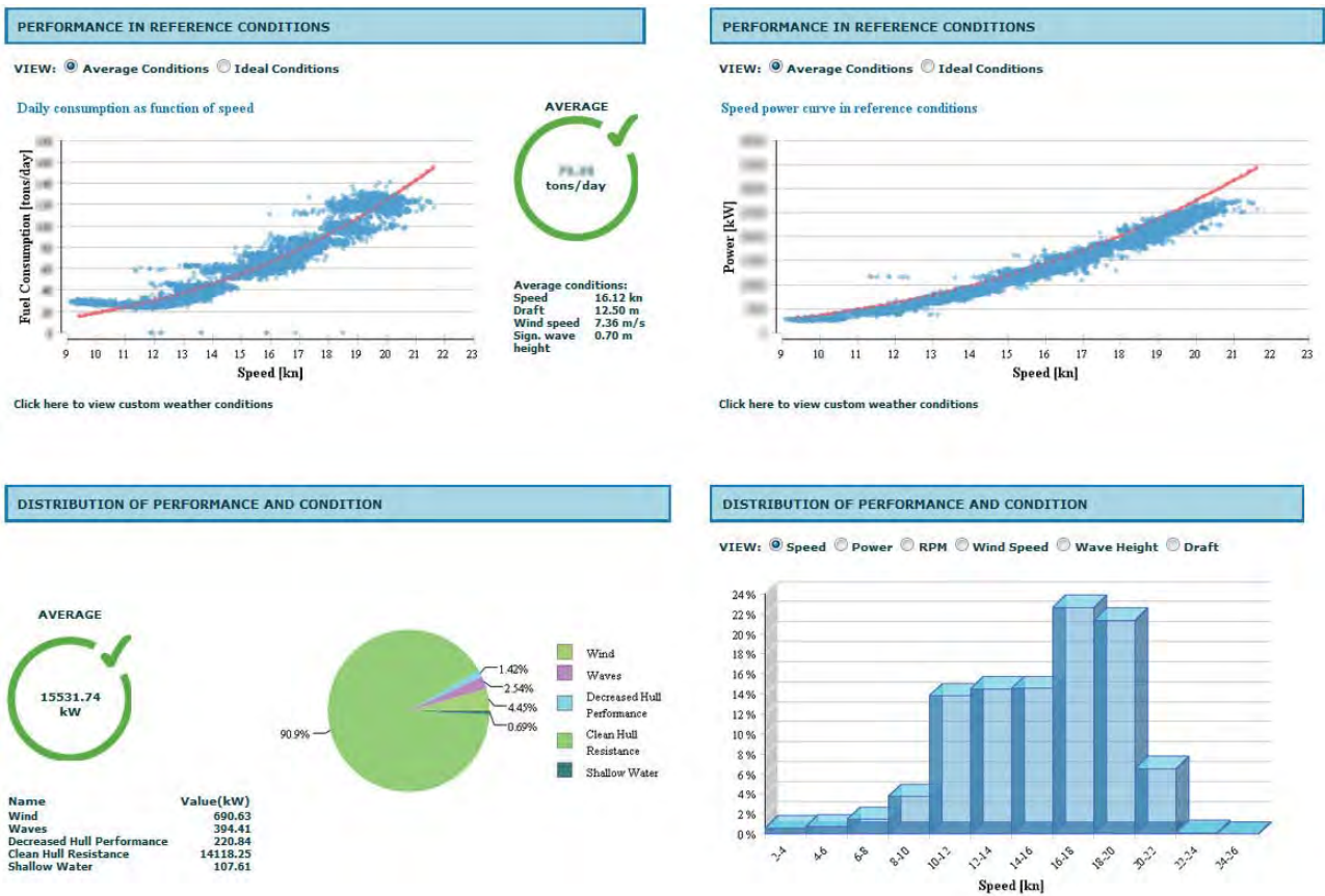
図7 就航実績解析 (基準状態パワーカーブと燃料消費の要因分析結果の表示例)
