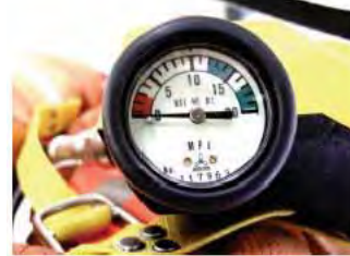
空気残量を確認できる圧力指示器
