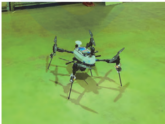
写真2 ビジョンセンサを搭載した自律飛行ドローン
