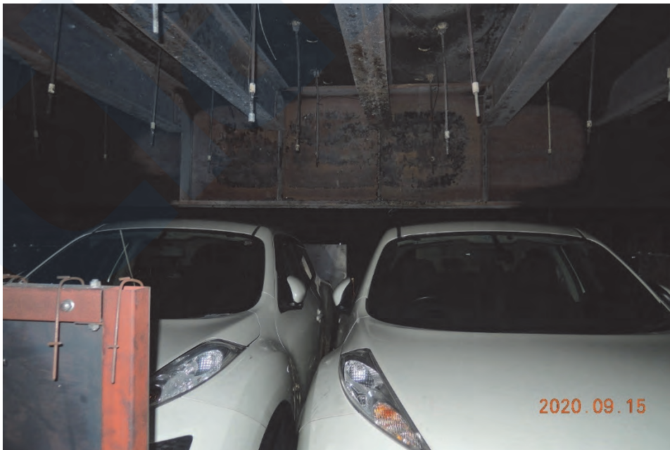
図5 車両燃焼実験の写真：水平配置の様子
