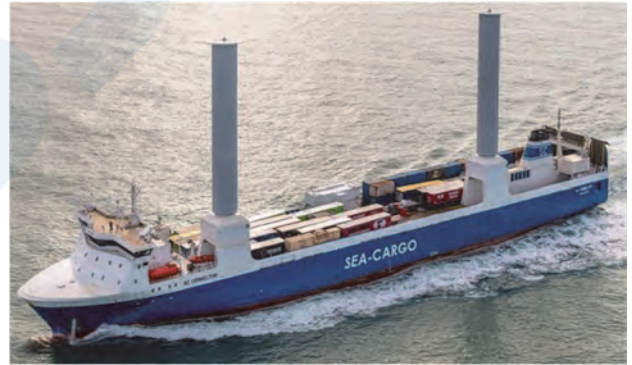
図9 ローターセイルを搭載した 8,660DWT RO-RO貨物船
