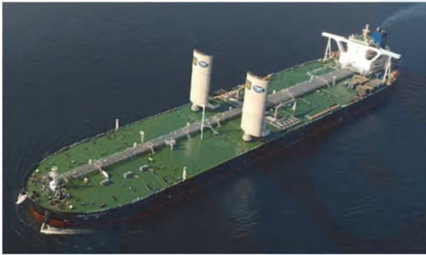
図8 二本の硬翼帆を搭載したVLCC (大連船舶重工)
