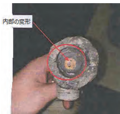
写真3 内部が変形した清水レベルスイッチ
