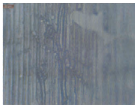
図4 シリンダライナに埋没したCat-finesとアブレイシブ摩耗の跡
