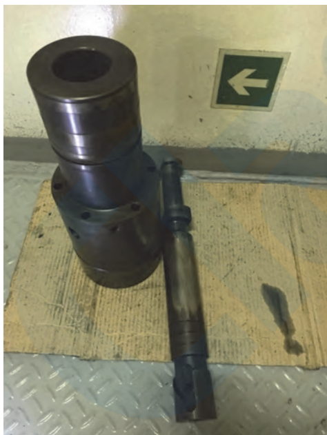
写真4 固着したプランジャとバレル
