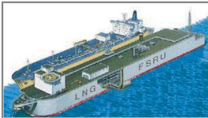
FSRUのイメージ図と発電バージの例(JMU提供)
