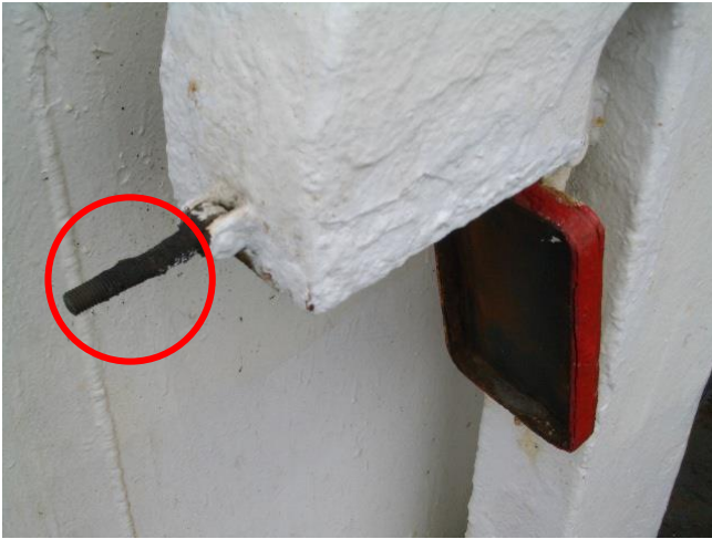
Gooseneck 환기장치의 나비형 너트 유실
