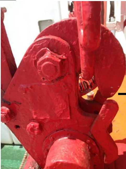
과도한 도장으로 인한 On-load Release Gear 의 고착
