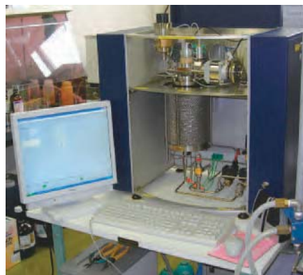
FIA-100FCA 를 이용한 연소 시험 (연소시험규격: IP541/06)
