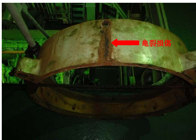
写真1 クーリングジャケットの亀裂(ボルト穴が起点となったケース)
