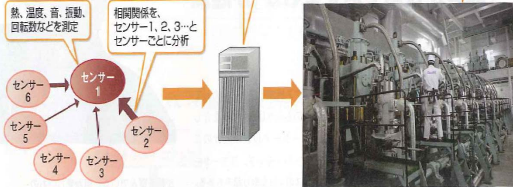
図8 ●日本海事協会が日本IBMと開発した、船舶のトラブル検知システム エンジンやボイラーなどに設置した数百個のセンサーが出力するデータの解析に、東京基礎研究所のソフトウェア技術を活用した
