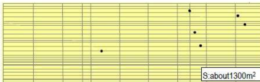
図A. Takamineの耐食鋼の5年目のピットマップ(深さ \geq 4 mm)
