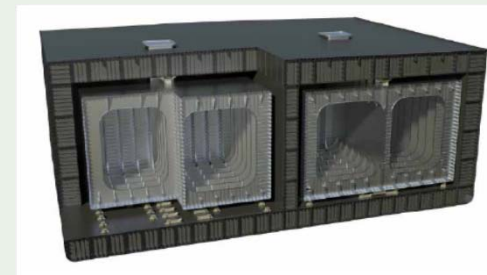
IMO type B 外部防熱タンク
