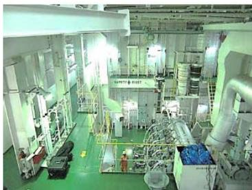
訪船調査時に、3次元レーザースキャナを用いて機関室内部の点群データを取得。
