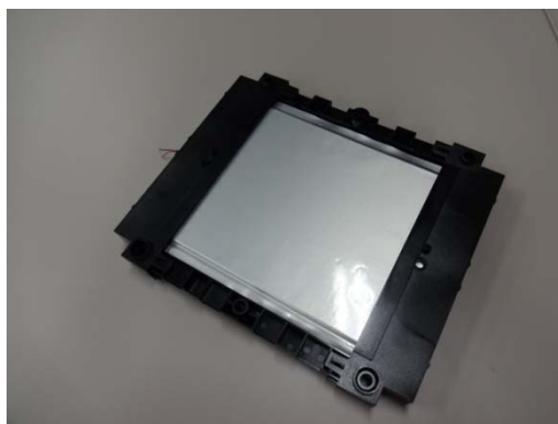
電池モジュール
