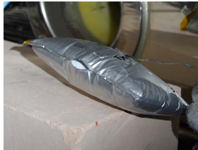
加熱試験により破れた電池セル
