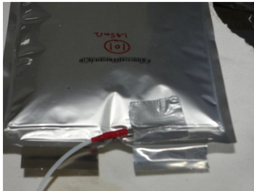
ガスを発生させた後に注射針を刺して吸引
