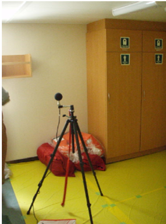
居室内騒音計測 (マイクの位置は床から1.2m~1.6mの間)
