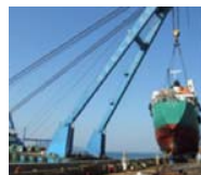
クレーンによる陸揚げ
