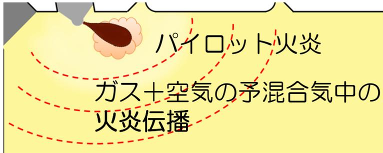
低圧ガス供給 (16気圧) で予混合気を作り、ピストンで圧縮・パイロットA重油で着火
