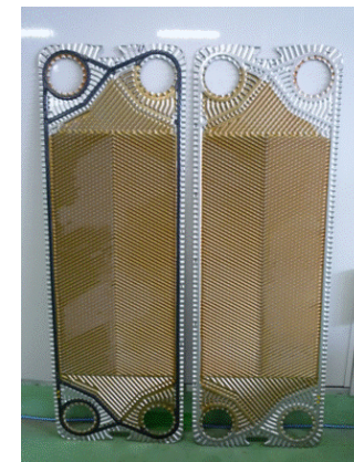
Fig.5.2 試験終了後のプレート面(T=70℃)
