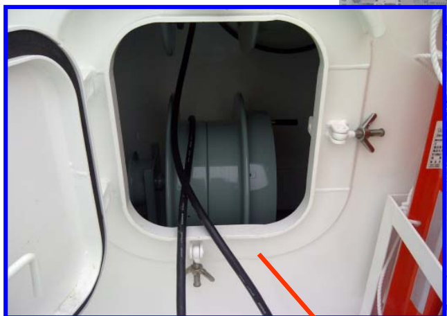
翼内格納の ケーブルドラム
