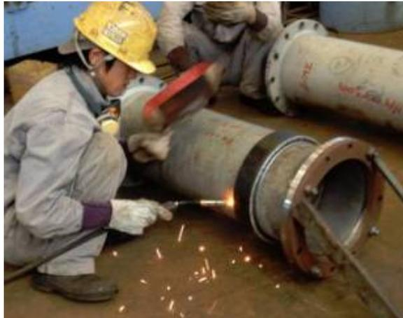
点群データで作成した管を金型と合わせるが、ズレが多く発生。
