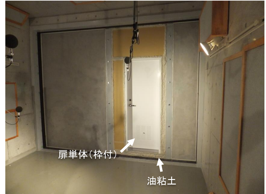
扉単体試験体 試験室内設置状況
