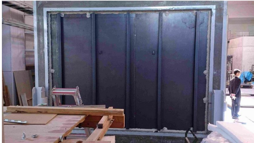
試験体 カートリッジ取付状況
