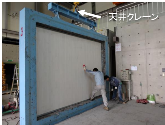
試験体 パネル施工状況
