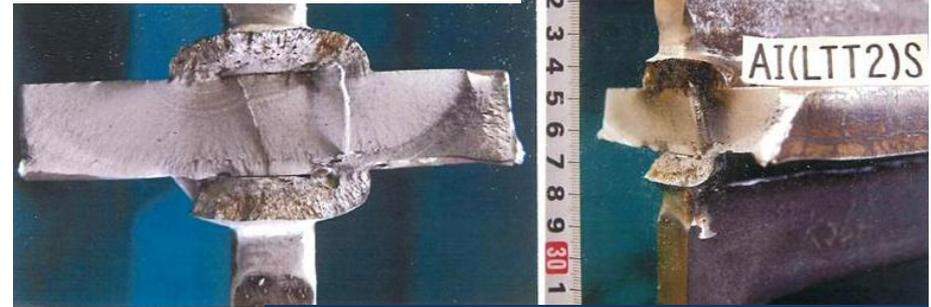
LTT2回し溶接金属のルート部から破壊
