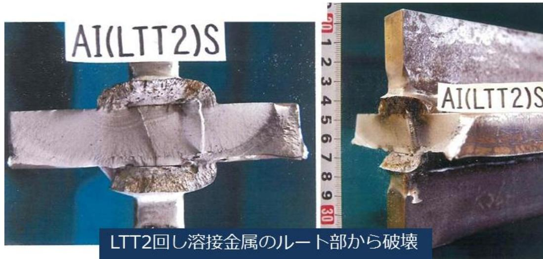
初期クラックの削り・補修溶接部ではなく，LTT2による回し溶接部のルート部から少ない繰返し数で亀裂発生・進展している。
