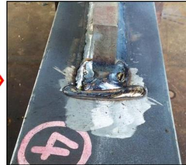
クラック部を補修溶接後、
