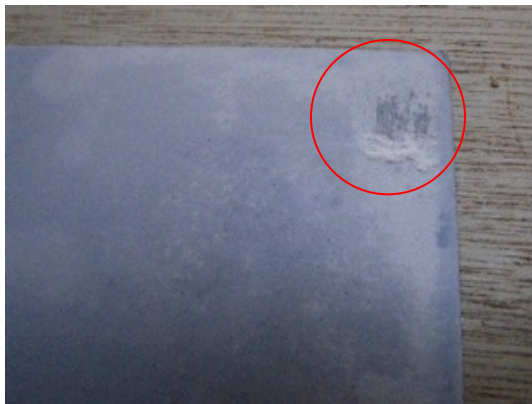
図2-1. 試験片の付着物
