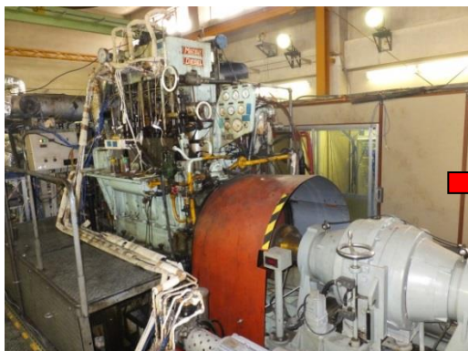
供試エンジン (定格出力257 kW)
