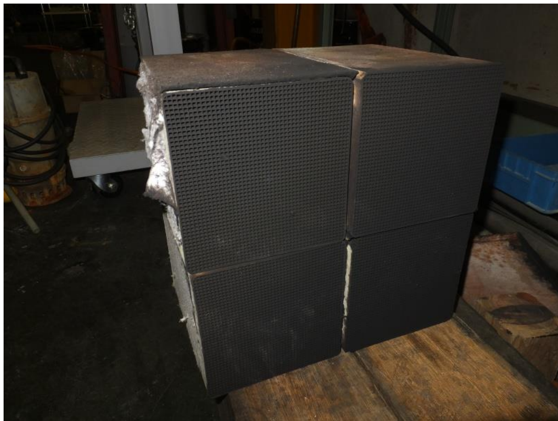
A重油で約15時間, C重油で約9時間の運転をした触媒(45セル)
