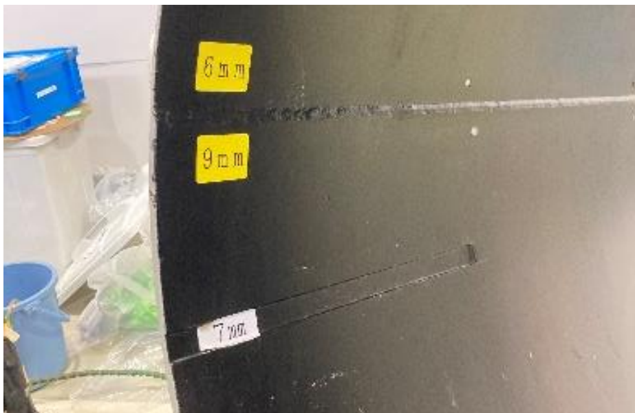
図5 模擬鉄管の板厚
