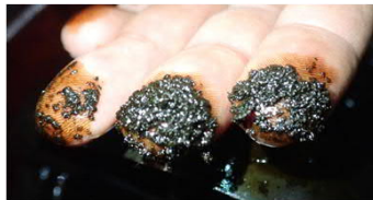
ストレーナーに詰まったスラッジ
