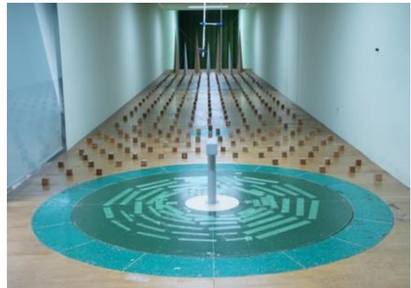
b) 乱流境界層生成装置設置状況
