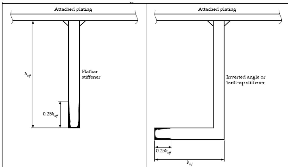
Figure 2 - Edge corrosion
