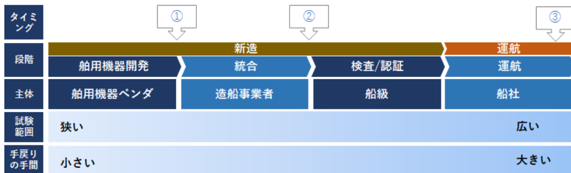
図 4.3.2 PT 実施タイミングと手戻りの手間・試験範囲の関係
