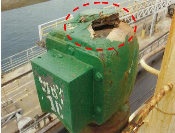
← 空気管頭の破孔
