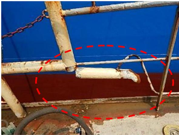
← ガードレールの支柱の破損
