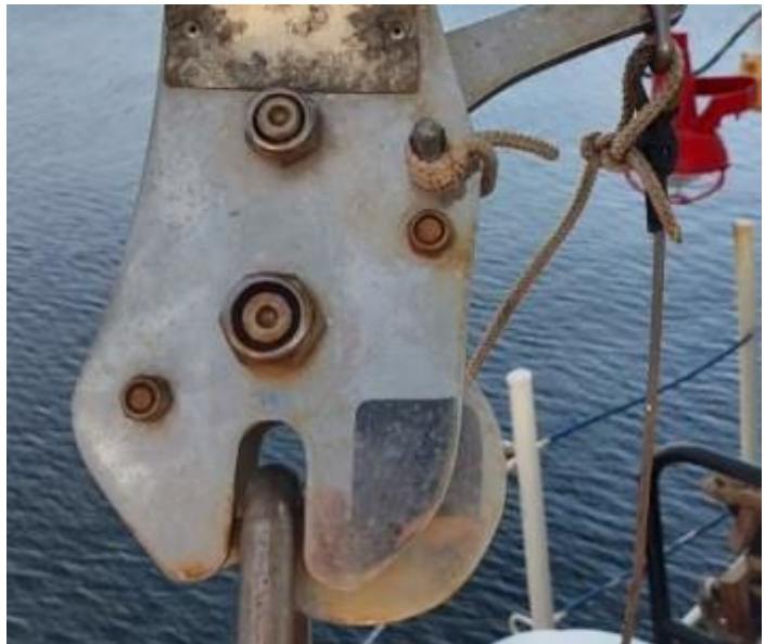
原型承認品ではない救命いかだ 離脱装置の使用
