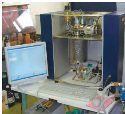
FIA-100FCAによる燃焼試験 (燃焼試験規格 IP541/06)
