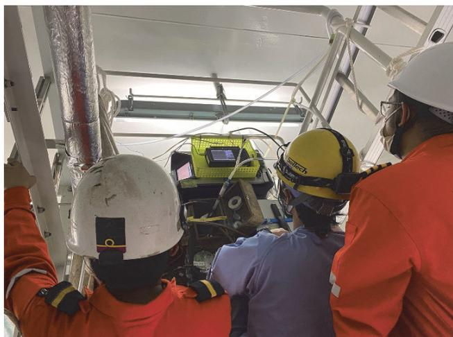
図9 船用機関より排出される排ガスの計測
