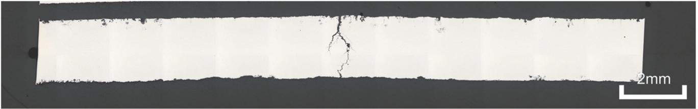
図6 HT80のSCC破面（浸漬期間：2週間）
