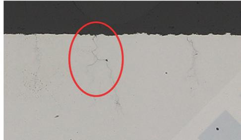
図7 HT80のSCC破面（浸漬期間：136時間）
