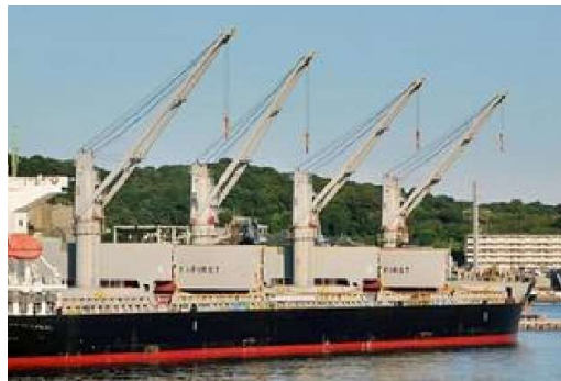
デッキクレーン
